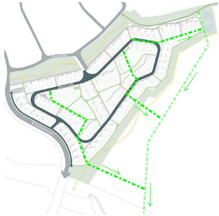
Figur 3 - Spillvannsløsning for B2
